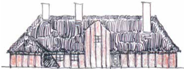
Tv.: Skitseforslag til Valnøddevænget 10 tegnet af Kay Fisker i 1917 med bindingsværk og stråtag.
